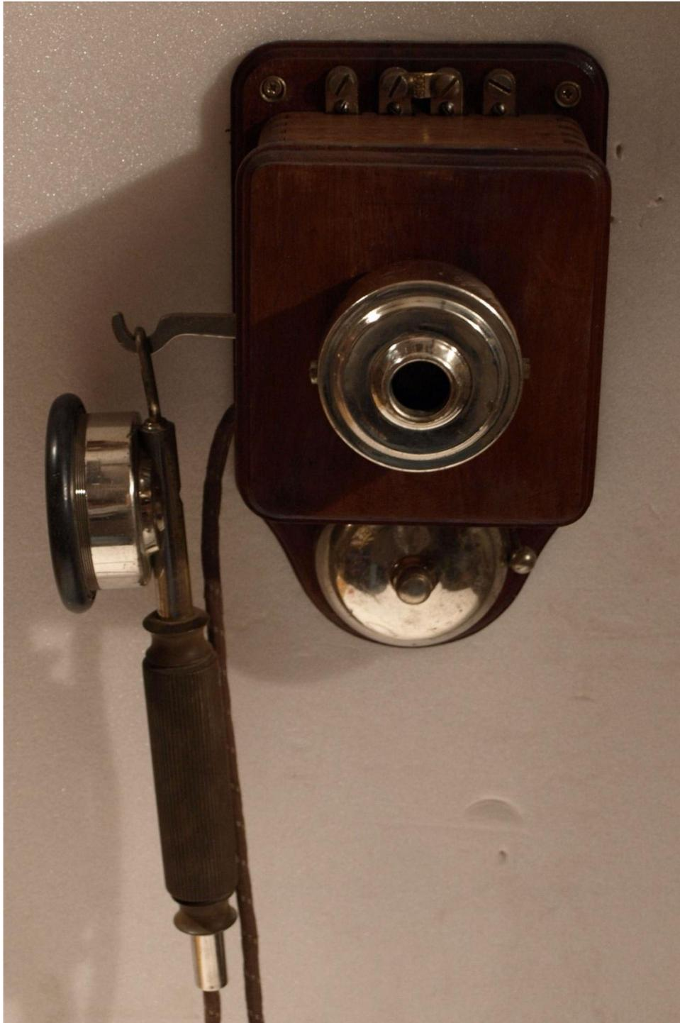
**Haus-Telephon-Apparat (Batteriestation). Wandstation Nr. 5912 bestehend aus poliertem Holzgehäuse, mit auswechselbarer Mikrofonkapsel, automatischem Hakenumschalter, einfachem Stieltelefon mit poliertem Griff und zweiadriger Schnur, Induktionsspule, Rufknopf Gleichstromwecker. (TEFAG Katalog 1925).**
